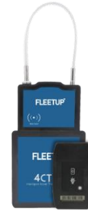
Seguimiento de frigoríficos FleetUp 4CT y control de temperatura
